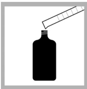
6. 将量筒内制备好的溶液倒入一只 BODTrak II 样品瓶。
