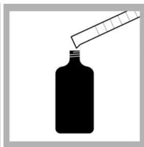
5. 将量筒内的溶液倒入一只 BODTrak II 样品瓶。重复步骤 1 至 5，添加更多样品。
