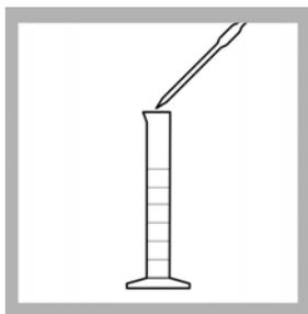
2. 用测量体积用吸管吸取 8.0 mL 哈希 GGA 溶液至量筒。
