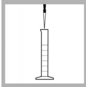
5. 如需加入晶种，则使用 Tensette 吸管吸取适量晶种溶液至量筒 (表 6 在第 23 页)。
