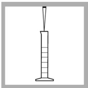
4. 使用 Tensette 吸管吸取适量晶种溶液至量筒（表 5）。
