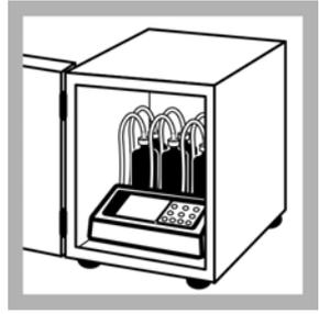
6. 插上电源，仪器通电。确保所有搅拌棒都在旋转。如搅拌棒不旋转，则将样品瓶上抬，再放下。
