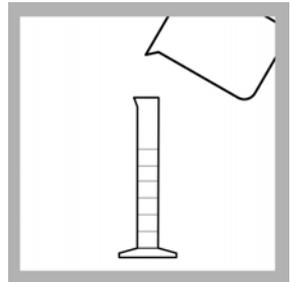
3. 根据样品范围选择正确的样品量 (表 4)。用量筒测量样品。
