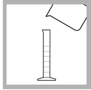
3. 根据样品范围选择正确的样品量 (表 6 在第 23 页)。用量筒测量样品。
