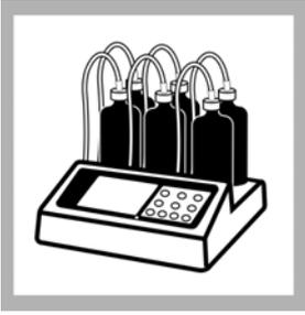
4. 将样品瓶放在 BODTrak II 基座上。将样品采集瓶与相应的管子连接，盖紧盖子。
