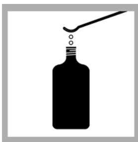
3. 用刮勺往密封杯内添加 2 粒氢氧化钾。对每只样品采集瓶重复步骤 1 至 3。
