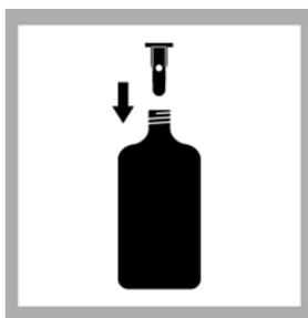
2. 将密封杯插入样品瓶瓶口。
