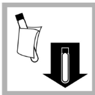
19. 将装有样品的试剂管擦拭干净，并将它放入16 mm圆形适配器中。
