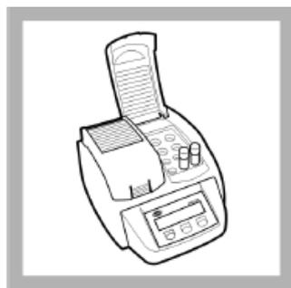
5. 将试剂管插入消解器，盖上盖子。加热消解正好30分钟。
