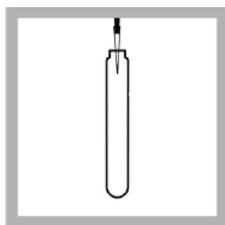
14. 计时时间结束后，打开两个TN C 总氮C试剂管，将2 mL样品消解液加入一个TN C 总氮C试剂管中，将2 mL空白值消解液加入第二个TN C 总氮C试剂管中。
