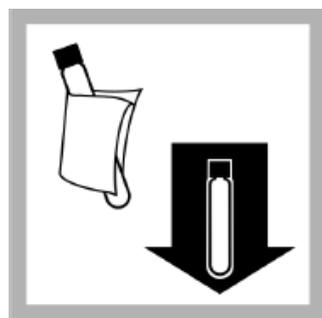
17. 计时时间结束后，将空白值的试剂管擦拭干净，并将它放入16 mm圆形适配器中。
