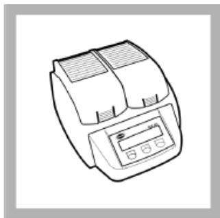
1. 打开DBR 200 消解器，加热至105 °C。
