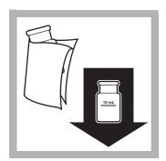
如果定时器到达规定时 9. 间,将空白试管插入试管固 0.00 mg/L浓度的NH<sub>3</sub>-N 定架,灌装线朝右。
