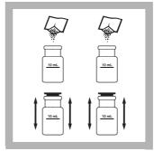
如果定时器到达规定 时间,请将一种氰尿酸氨 试剂粉包的内容添加到各 试管中。
